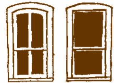
Non : Le sommet en arche a été retiré. Des traverses verticales ont été retirées. Le style et les dimensions d'origine ont été perdus.
