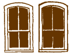
Oui : Dimensions du châssis exactes. Traverses fines.
